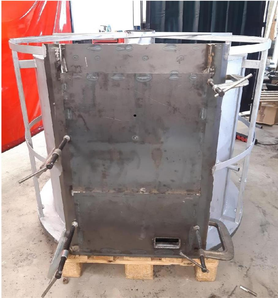
Positionnement vertical de la porte : disposer une cale d'épaisseur sous chaque porte (épaisseur égale ou légèrement supérieure à la moitié du jeu vertical entre la porte et l'encadrement de porte).
