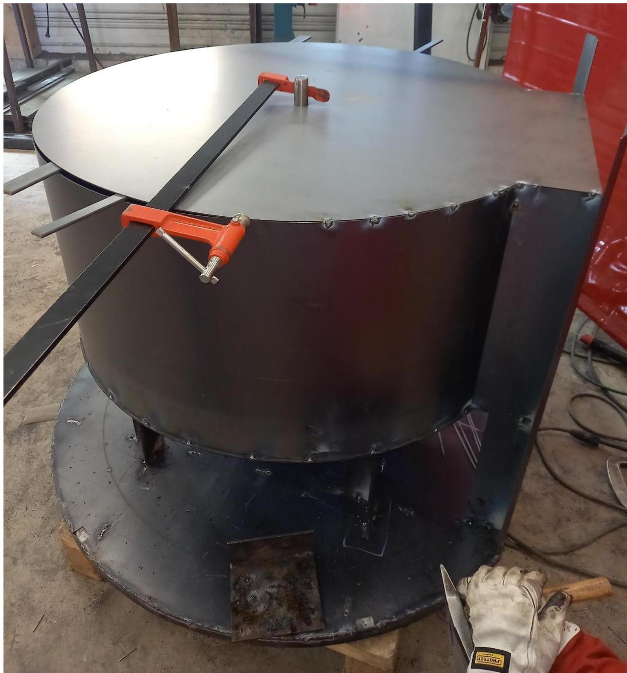
Il ne faut pas essayer de le positionner bien des deux côtés en même temps. Commencer par un coin (1), positionner correctement et pointer. Pointer ensuite à l'emplacement 2. Faire la
