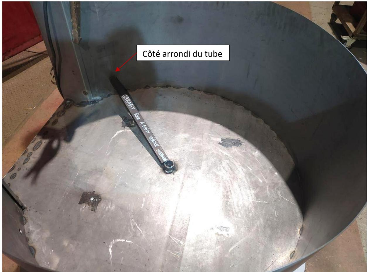
**IMPORTANT** : A cette étape, on ne fait que pointer ! La soudure complète sera faite une fois le couvercle pointé lui aussi, pour limiter les déformations gênantes.
