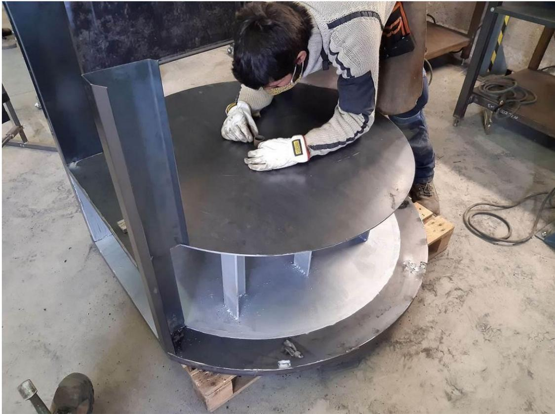
Pointer puis souder le petit tube qui reçoit l'axe bien au centre (sur le trait de gravage fait au laser). Il doit rester bien vertical !
